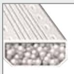
Los **distanciadores de aluminio** son resistentes a la temperatura, la radiación ultravioleta y al envejecimiento, absorben cargas dinámicas y poseen un coeficiente de transmisión térmica lineal de 0,064 W/(mK).
