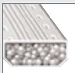
Los distanciadores de aluminio son resistentes a la temperatura, la radiación ultravioleta y al envejecimiento, absorben cargas dinámicas y poseen, con coeficientes de transmisión térmica lineal de 0,064 W/(mK), buenas propiedades de aislamiento térmico.
