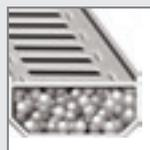
Los separadores de acero inoxidable se componen de material con un mejor aislamiento térmico con un coeficiente de transmisión térmica lineal de 0,048 W/(mK) con un vidrio termoaislante triple. De esta forma se minimiza el riesgo de formación de líquido de condensación por encima de los junquillos de vidrio.
